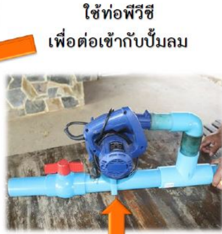
ระบบเติมอากาศใช้ปั๊มอัดลม ขนาด 0.5 แรงม้า
