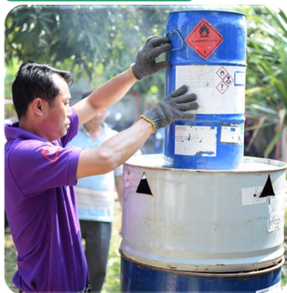
7. วางปล่องควันที่ทำจากถัง 30 ลิตร ไว้บนห้องเผาไหม้
