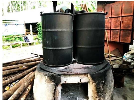
หม้อต้มไอน้ำที่ติดตั้งเองจากถังน้ำมันขนาด ๒๐๐ ลิตร
