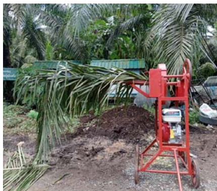
ภาพแสดง การใช้เครื่องสับย่อยทางปาล์มน้ำมัน ย่อยทางปาล์มน้ำมัน
