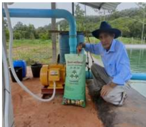
ภาพการประยุกต์การให้ระบบน้ำภายในสวนพร้อมปุ๋ยละลายน้ำ สารกำจัดศัตรูพืชหรือชีวภัณฑ์
