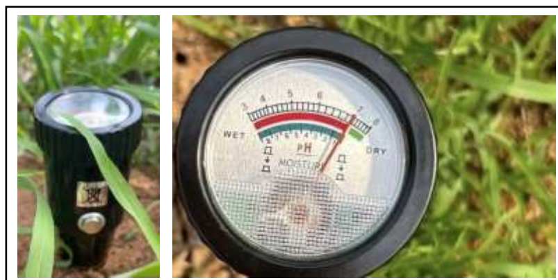
ภาพที่ ๑๕ ระบบตรวจวัดความชื้นดิน
