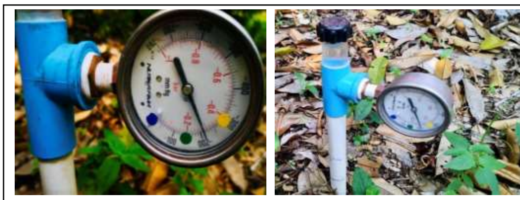
ภาพที่ ๒๒ อุปกรณ์วัดความชื้นดินแบบ Tensiometer
