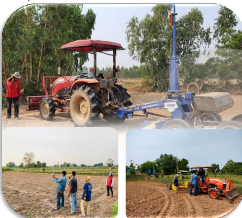
ภาพการปรับพื้นที่นาด้วยเลเซอร์ (Laser Land Leveling)
