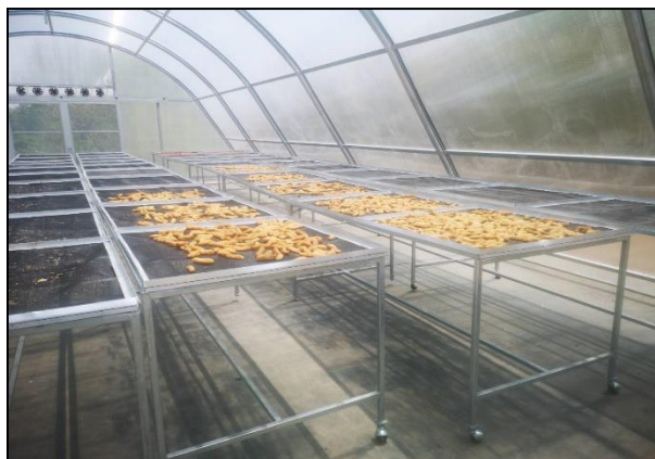
ภาพที่ ๔๑ ระบบอบแห้งพลังงานแสงอาทิตย์แบบเรือนกระจก
