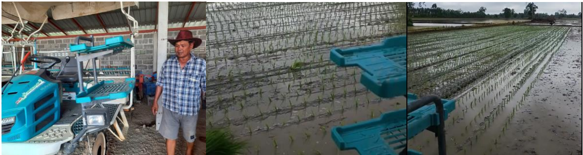
ภาพที่ ๑๗ รถปลูกข้าวแบบนั่งขับและการปลูกข้าวโดยรถปลูกข้าว
