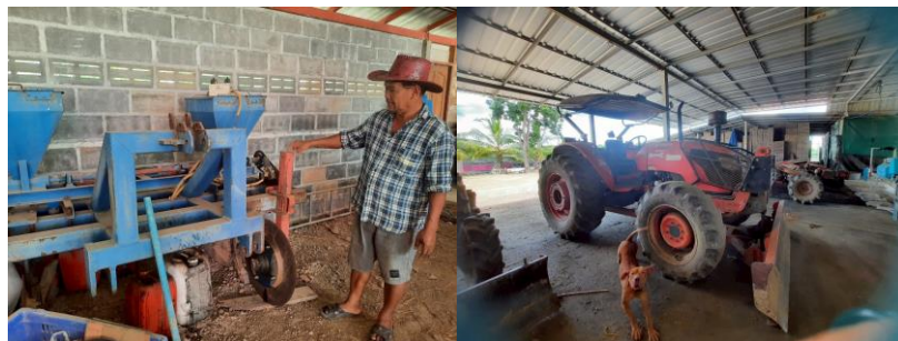
ภาพที่ ๑๔ แผ่นเหล็กสำหรับติดตั้งกับรถแทรกเตอร์เพื่อปรับหน้าดินในแปลงข้าว
