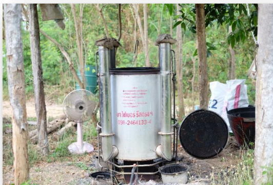
ภาพที่ ๗ การทำน้ำส้มควันไม้
